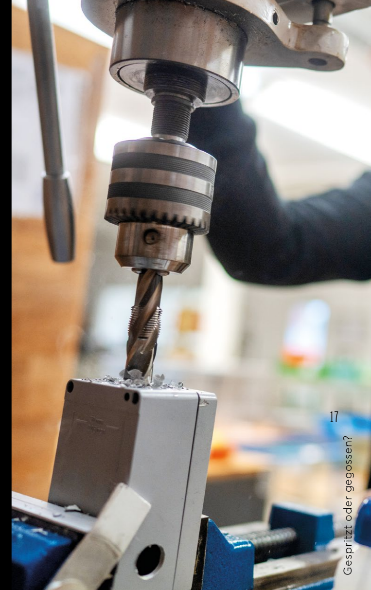
Viel Handarbeit: Neben der CNC-Maschine wird auch mit dem Standbohrer gearbeitet.
